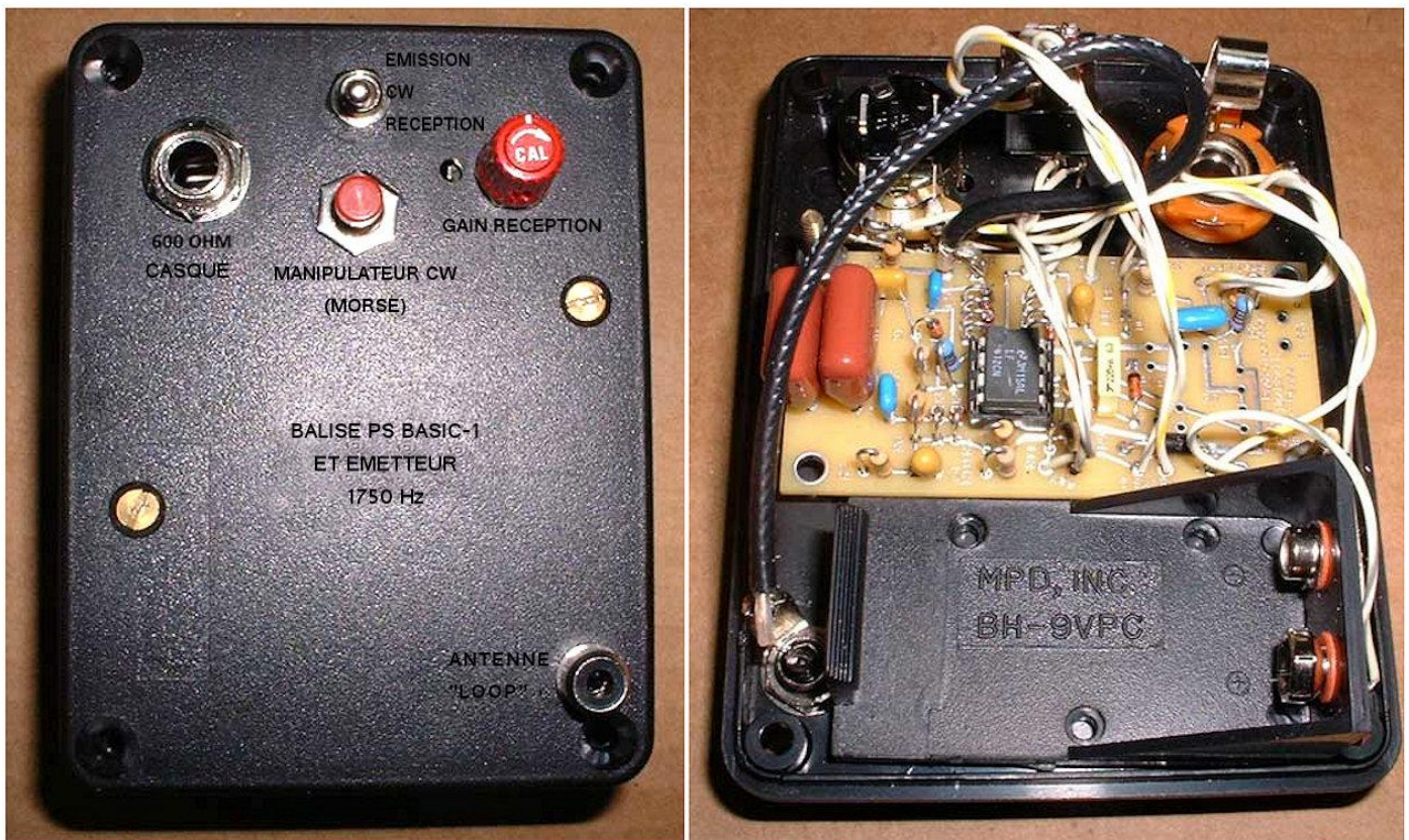
Figure 5 : montage du boîtier et du couvercle
